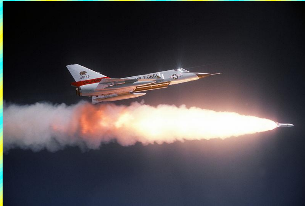
Intercepteur américain F-106A Delta Dart tirant un missile air-air à capacité nucléaire
